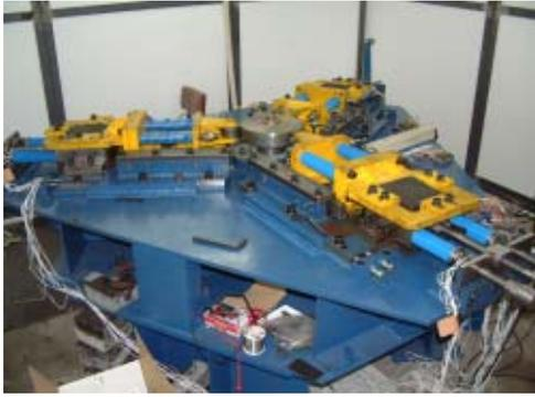
写真-9 せん断着疲労試験機全景
