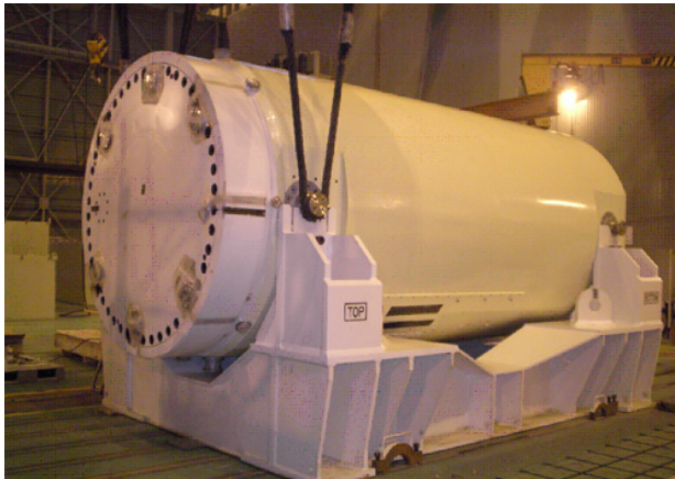
図-14 金属キャスクの外観図
