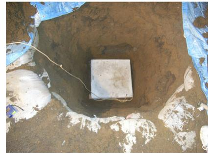
(a) 埋設前の鉄筋コンクリート板
