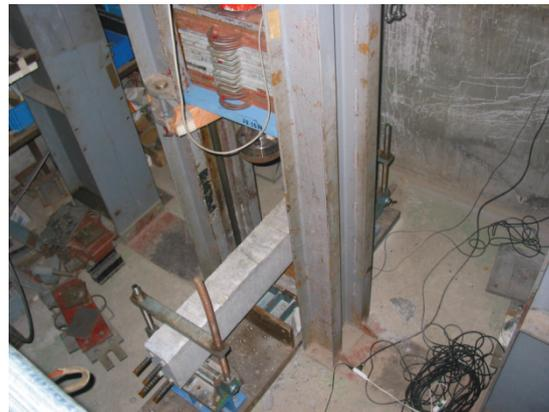
写真-2 RC梁の衝撃载荷実験
