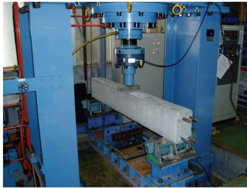
写真-1 RC梁の急速曲げ載荷実験
