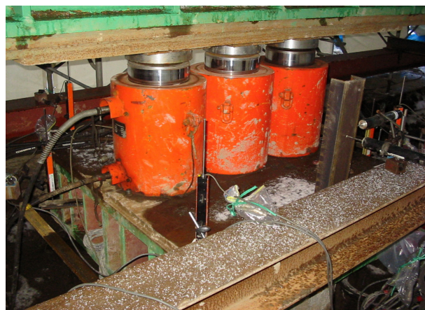
写真-2 複合地盤杭の鉛直載荷試験状況(その 2)
