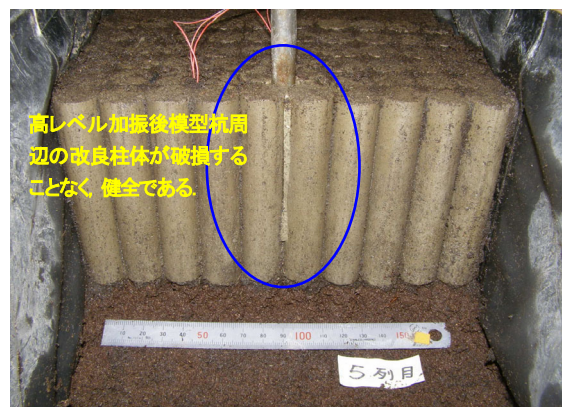
写真-5 地震動加振後の改良柱体
