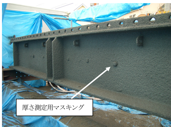
(b) 孔あき鋼板ジベル供試体 (B 体) の状況
