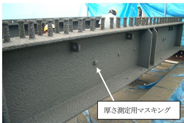
(a) 頭つきスタッド供試体 (A 体) の状況
