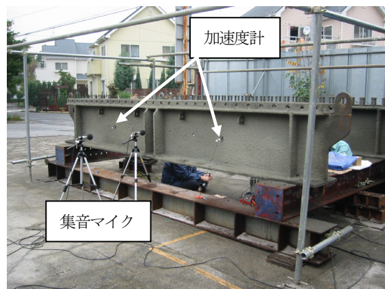
図-6 衝撃加振試験状況 (A 体) (ゴムラテックスモルタル吹き付け後)
