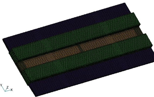
図-18 SRC桁FEM解析メッシュ図(鳥瞰図)
