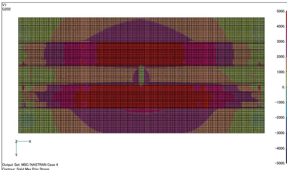
図-26 SRC 桁 FEM 解析結果，床版コンクリート下面，
