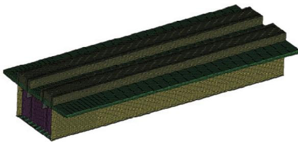
図-6 合成桁 FEM 解析メッシュ図 (鳥瞰図)
