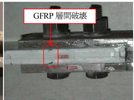
(a) 破壊状況
