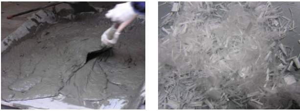
写真-1 高靱性セメント材料打設時の様子 (左) と使用した PVA 繊維 (右)
