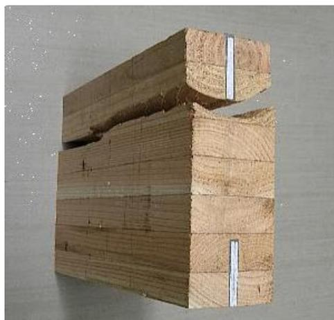
図-9 梁中央における Type-A のせん断破壊 (xy 断面)
