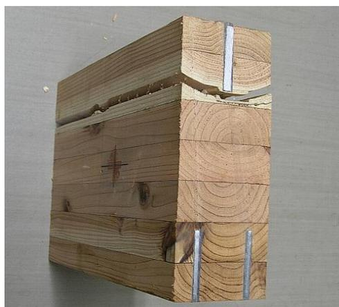
図-10 梁中央における Type-B のせん断破壊 (xy 断面)
