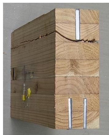
図-11 梁中央における Type-C のせん断破壊 (xy 断面)
