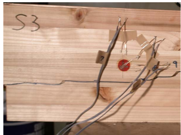
図-6 せん断破壊状態 (スギ試験体 No.5)
