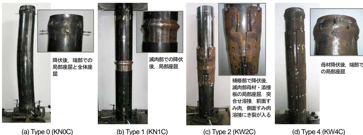
図-5 圧縮実験供試体の崩壊形式
