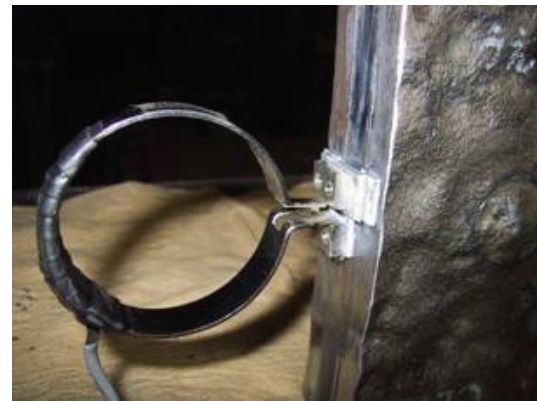
図-11 相対ずれ計測状況
