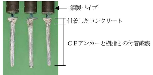
写真-2 コンクリートから抜出したCFアンカー
