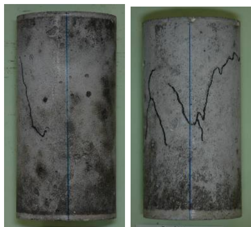
(a) 4回載荷 (b) 8回載荷 写真-4 補修後のひび割れ供試体
