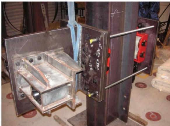
図-7 落下装置ケーブル連結部
