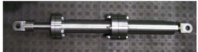
図-2 ダンパー供試体
