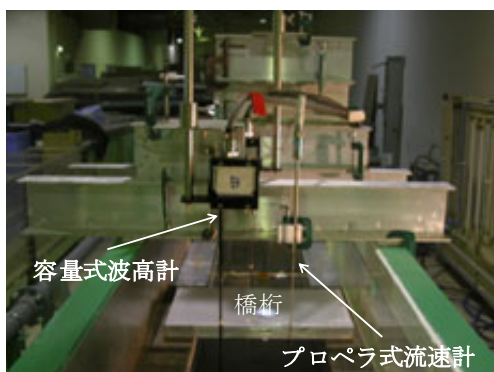
写真2 計測器の設置
