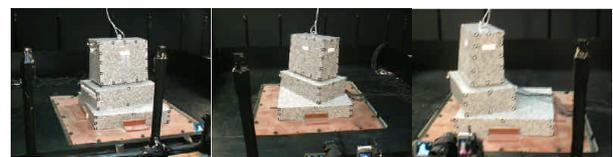
写真-4 モデルY2の結果(左から、震度6弱・6強・7加振後)
