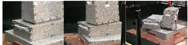
写真-3 モデルY1の結果(左から、震度6弱・6強・7加振後)
