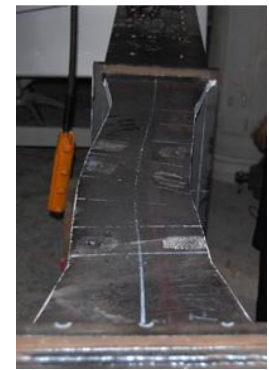
写真-3 橋軸方向 載荷後供試験体(C87-4)
