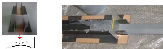
図-8 接着樹脂塗布治具
