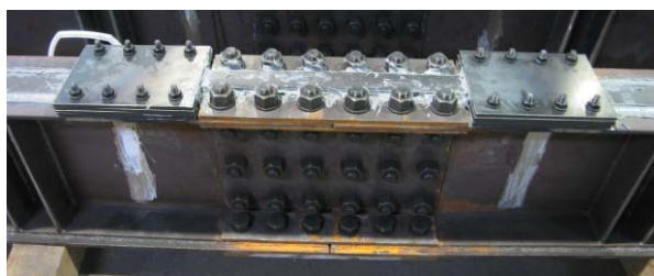
図-16 継手部の高力ボルト配置 (実験供試体 He-Rt および He-R)
