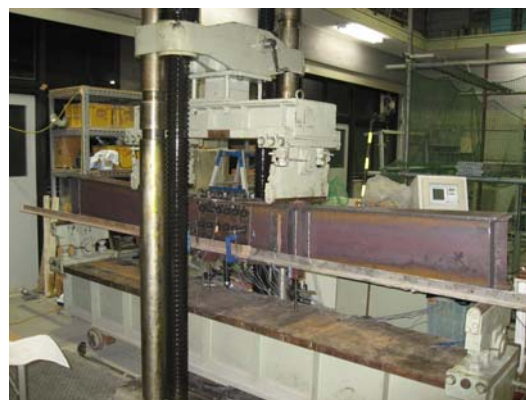
図-7 実験供試体の設置状況
