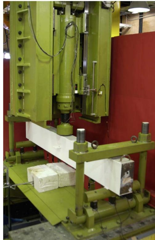
写真-1 衝撃荷重実験の状況
