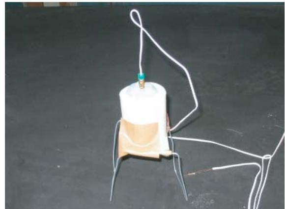
(b) 近接爆破の爆薬設置状況
