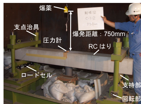
写真－１ RC はりを用いた爆発実験の状況
