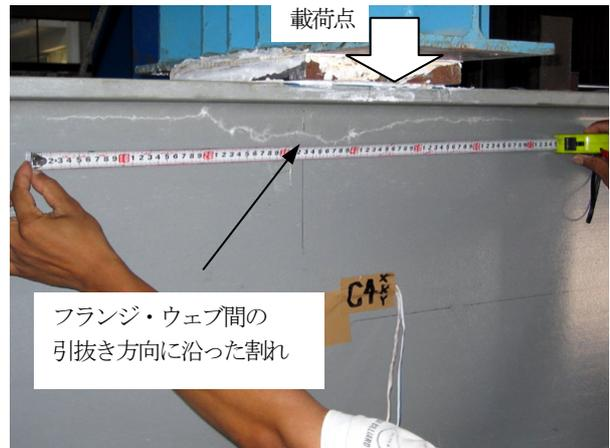
写真-8 2000 A の破壊状況
