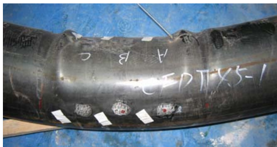
図 10 CFDT 外鋼管の座屈
