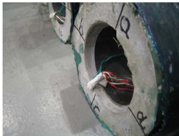
図 14 CFFT の内鋼管とモルタルのずれ
