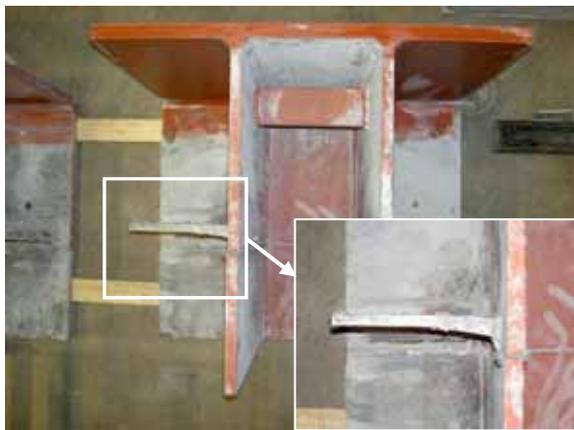
写真 - 7 プレートの変形状況( No.2- 供試体 )
