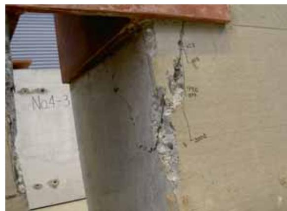
写真 - 2 破壊状況 : (No.3- 供試体) 近景
