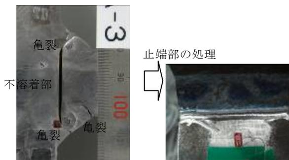
図-5 ルート部および止端部の亀裂
