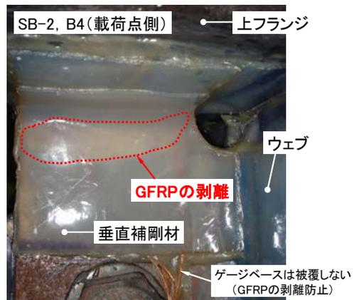
写真-3 対傾構モデルにおけるGFRPの剥離状況
