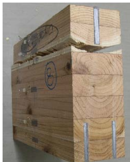
図-14 上部鋼板下端付近でのせん断破壊
