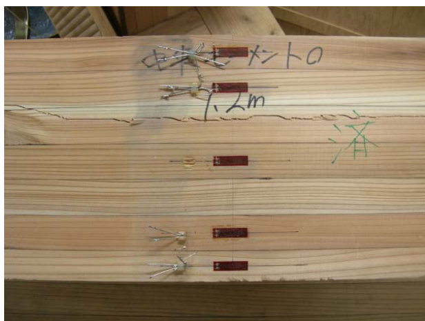
図-13 せん断破壊した供試体
