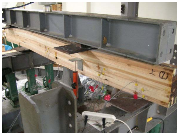
図-11 逆対称四点曲げ試験
