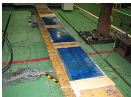
図-5 CFRPにより補修した供試体
