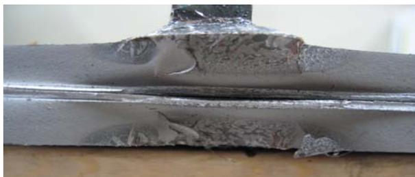
図-7 代表的な疲労破面の例
