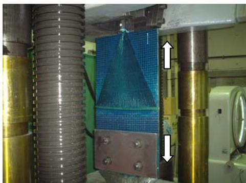
写真4. CFアンカー扇部接着耐力確認試験方法 (鋼板下地)
