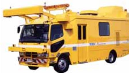
写真-1 路面計測車
