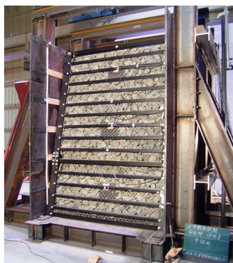
写真-4 中詰材を詰めた供試体
