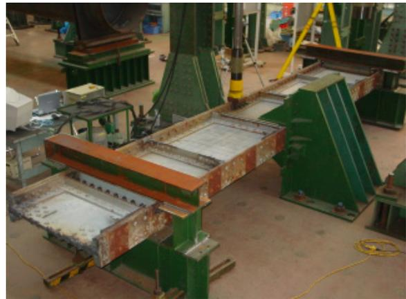
図-9 面外変形付与時の荷重状況
