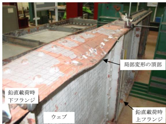
図-6 局部変形付与後の変形状況
