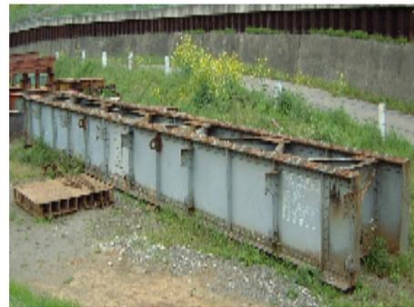
図-2 試験体に用いた主桁（加工前）
