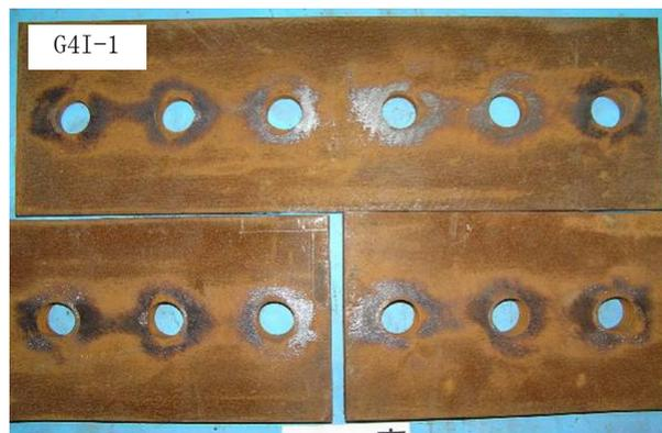
写真-3 試験後の接合面の例
