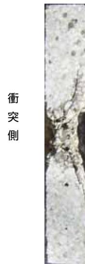
写真-5 断面の破壊状況（裏面剥離）
