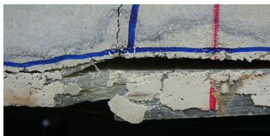
図-16 継手C破壊図
