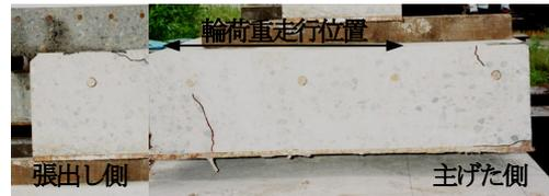
写真-3 試験体の橋軸直角方向の切断面 (B-B断面)
