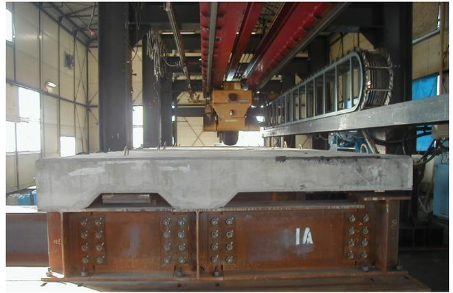
写真-1 張出し部の走行試験の試験体
