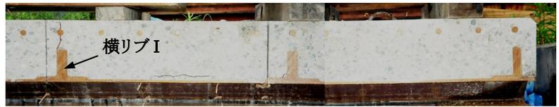
写真-2 試験体の橋軸方向の切断面 (A-A断面)
