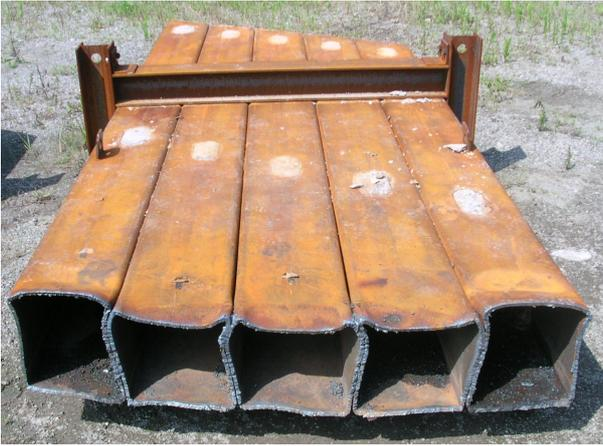
写真-4 中央部断面の切断面
