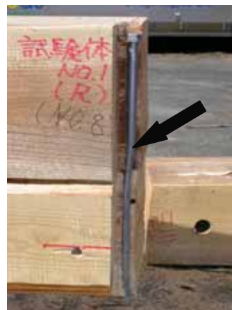
写真-4 試験終了後のボルトの様子 (B-11)
