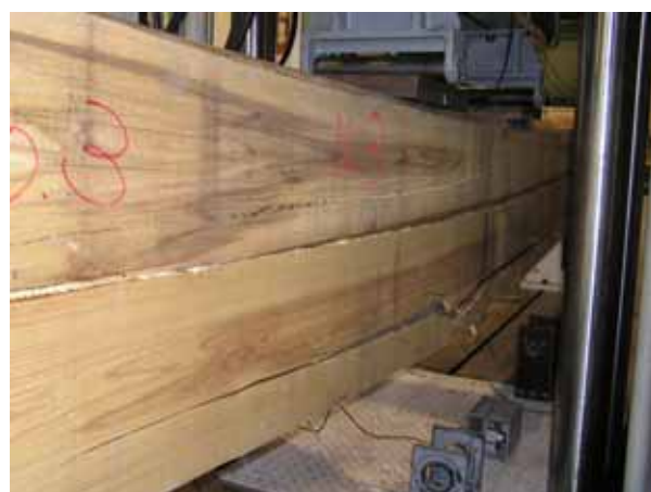
写真-3 中央部の破壊の様子 (B-13)
