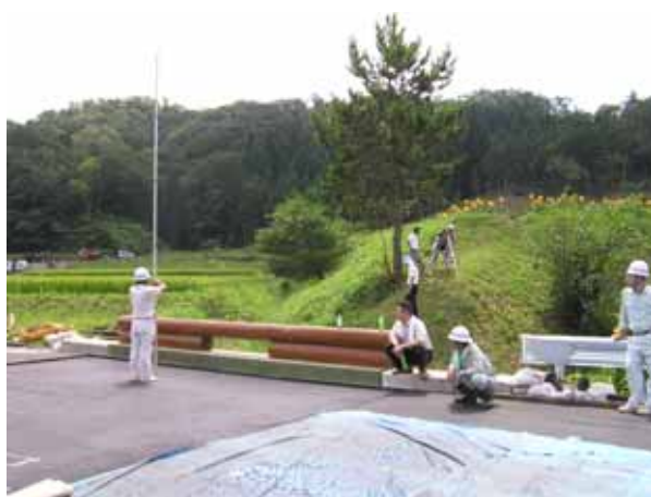
写真-6 モデル木橋の載荷試験の測定の様子
