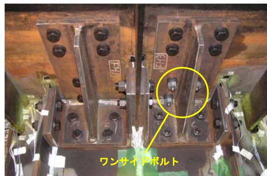
写真-5 疲労試験体へのワンサイドボルトの適用
