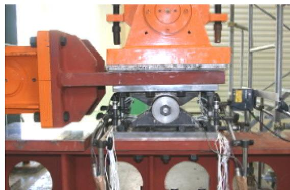
図-12 実験時の載荷状況（近影，橋軸方向加振時）
