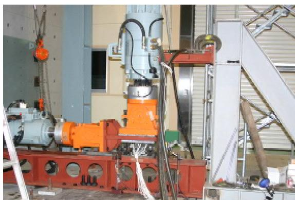
図-11 実験時の載荷状況（全体，橋軸直角方向加振時）
