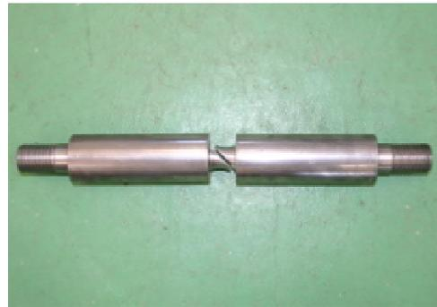
図-21 ピンくびれ部破断状況
