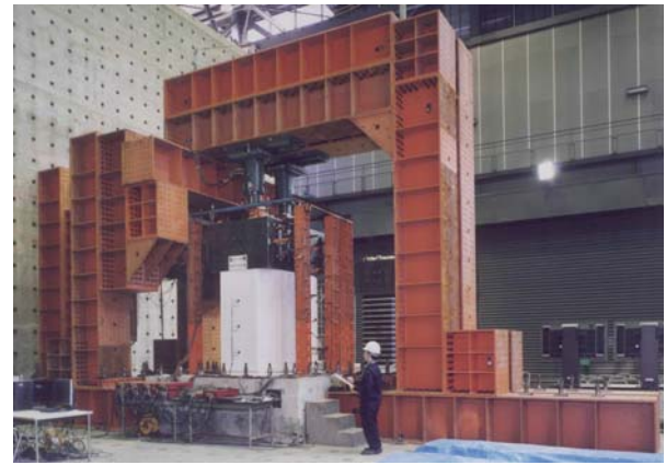
写真-3 荷重装置
