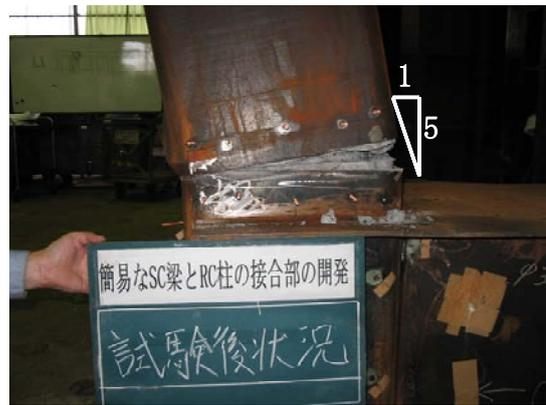
写真-3 試験終了時試験体状況 (写真-2 中 a 部拡大)
