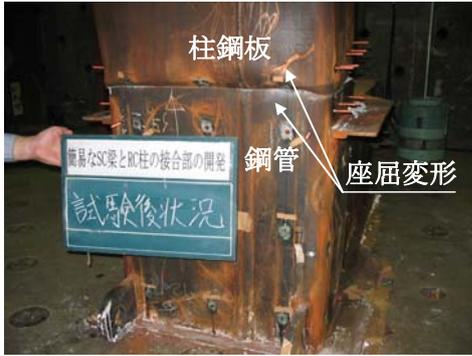
写真-6 柱鋼板・接合部鋼管状況 (試験終了時)
