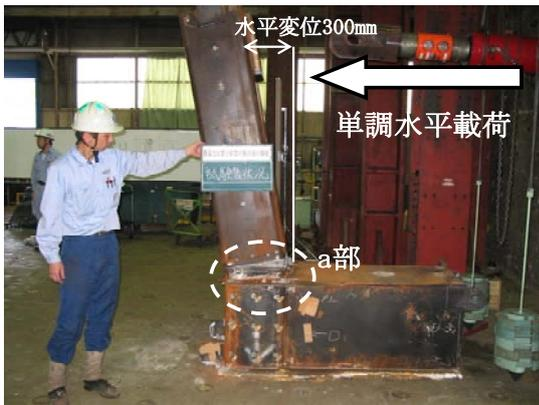
写真-2 試験終了時試験体状況
