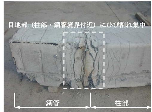
写真-5 柱・接合部境界付近状況 (試験終了時)
