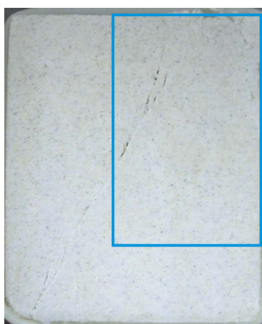
写真-3 実験後の供試体（拘束圧 1.0 MPa）
