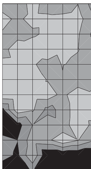
図-26 最大せん断ひずみ分布 (2.85%, 1.0 MPa)
