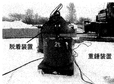
写真-1 重錘および重錘脱着装置
