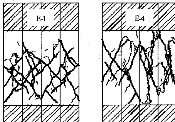
図-12 試験体 E-1 と E-4 のひび割れ展開図
