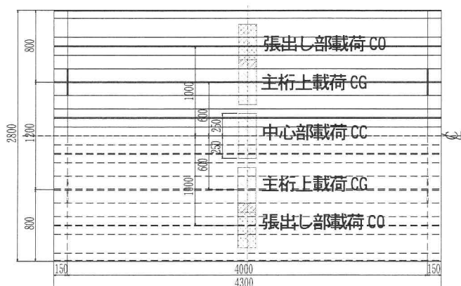
図-5 供試体Ⅰにおける載荷位置
